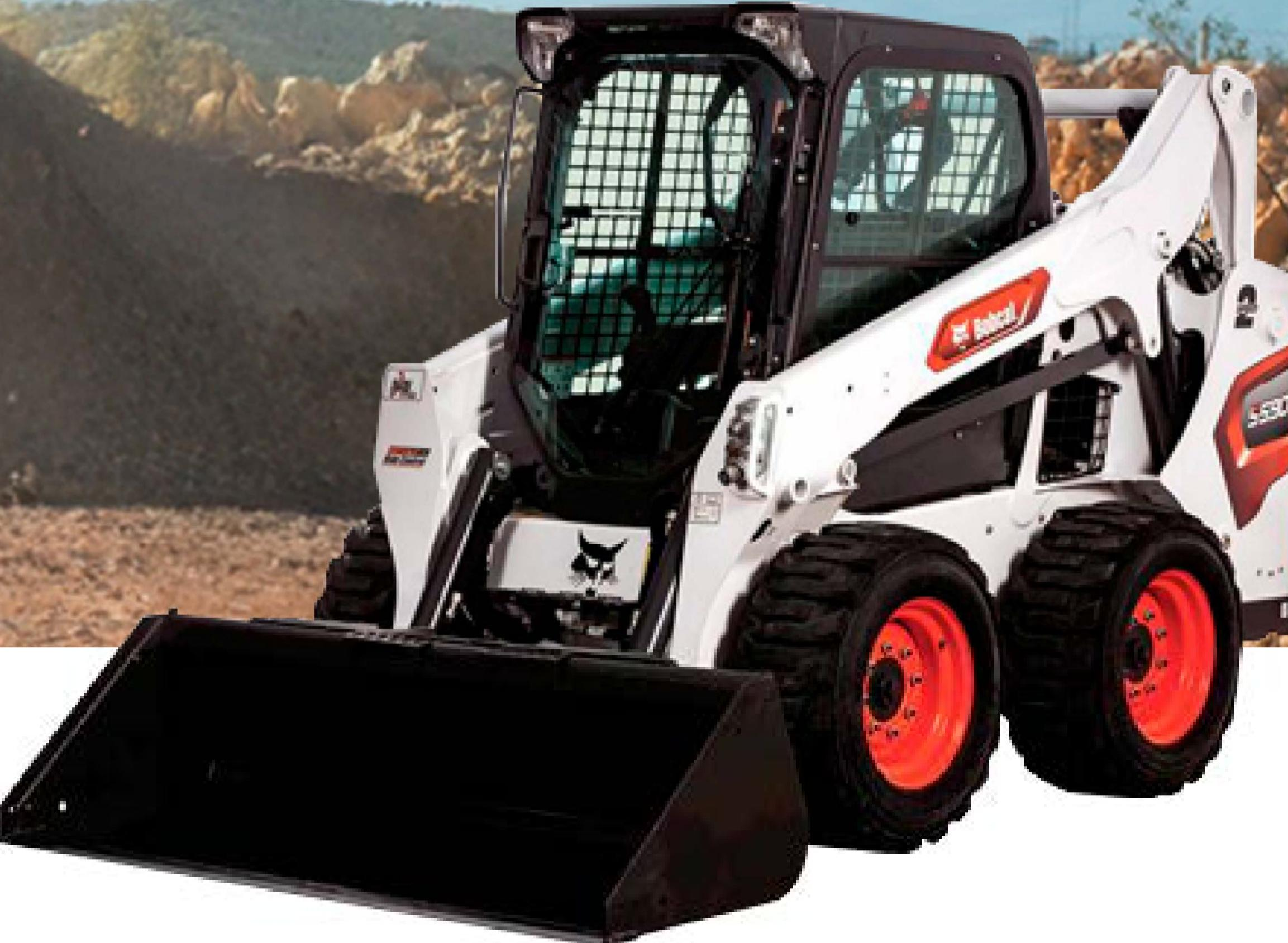
El S530 Bobcat es el cargador más pequeño con trayectoria de elevación vertical, perfecto para cargar camiones o mezcladoras que necesitan más alcance y altura de elevación en el tope del ciclo de elevación. El S530 es una elección popular entre las unidades de su tamaño.
